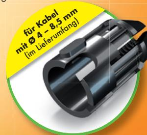
**HICON** liefert ab sofort ein neues, **extrem robustes Steckergehäuse** und die dazugehörige **Einbaubuchse** für alle RJ 45 Verbinder (CAT.5e, CAT.6a). Das Gehäuse und die Verschlusskappe sind aus Metall, der Verbinder besitzt eine zuverlässige Spannzugentlastung und eine Aufnahme bis AWG22. Der robuste Knickschutz kann mit Farbkodierringen versehen werden.
