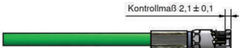
Crimphülse vorsichtig über das Geflecht bis zum Kontaktkörper heranschieben und möglichst nahe am Kontaktkörper crimmen.
