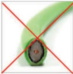
Schnitt mit Seitenschneider
