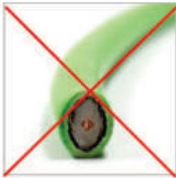
Schnitt mit Seitenschneider
