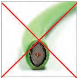
Schnitt mit Seitenschneider
